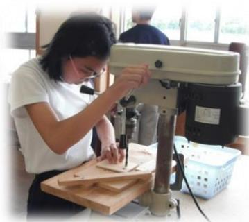
ボール盤を使って正確な位置にきれいな穴が開くように作業しています。
